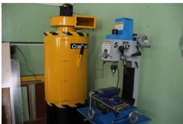
Станок сверлильно-фрезерный и система удаления стружки
