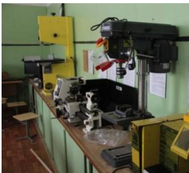
Станок токарный по металлу, станок сверлильный, токарный по металлу, пила ленточная
